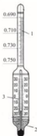
Рисунок 1а. Устройство ареометра: 1 – шкала ареометра (проградуирована в г/см^3 ); 2 – дробь; 3 – шкала термометра (проградуирована в ^{\circ}C )
