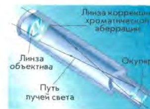
Рис. 17.4. Ход лучей в телескопе-рефракторе
