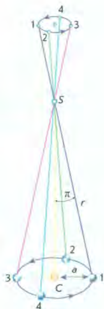
Рис. 22.1. Параллактическое смещение звезды на протяжении года: C — Солнце; S — звезда; a — полуось земной орбиты; \pi — годичный параллакс
