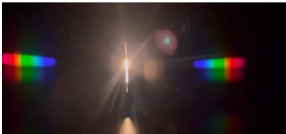
Figura 2: Espectro obtido após a observação da fonte luminosa vela pelo espectroscópio
