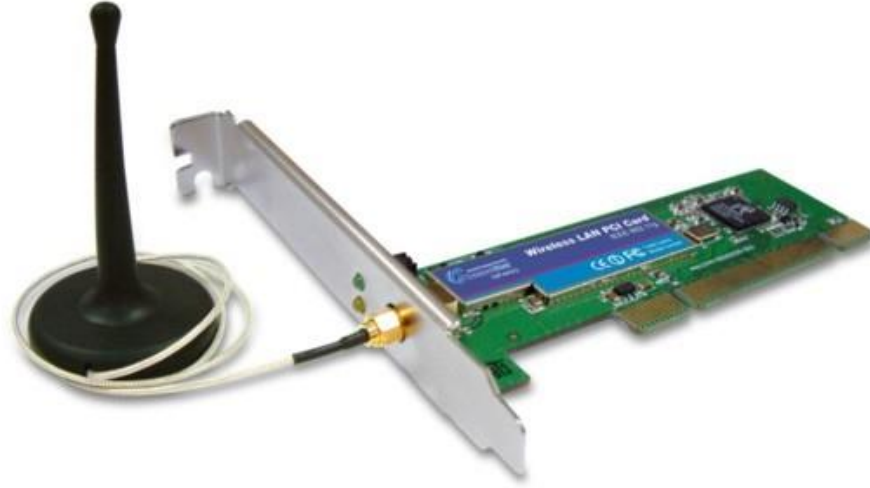
802.11g (Wi-Fi) destekli bir kablosuz PCI ağ kartı
