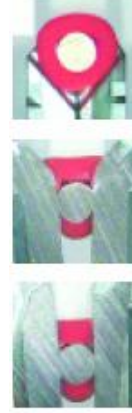
Resim 4.44: Konağa iletkenin sabitlenmesi
