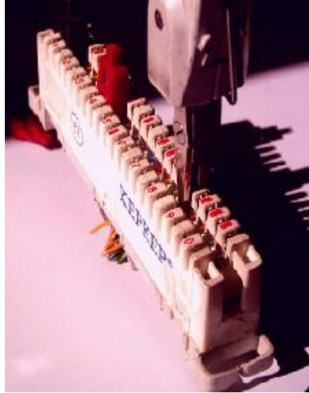
Resim 4.32: Krone bıçağı ile modüle kablo irtibatlama
