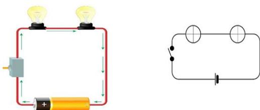
Circuito Elétrico em série é aquele em que existe uma associação. A partir dessa associação, os componentes ligam-se entre si na mesma sequência e na mesma direção.
