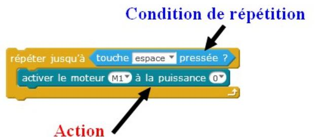
Tant que la condition est remplie ( OUI ), l'action est réalisée, dans le cas contraire (NON), on sort de la boucle
