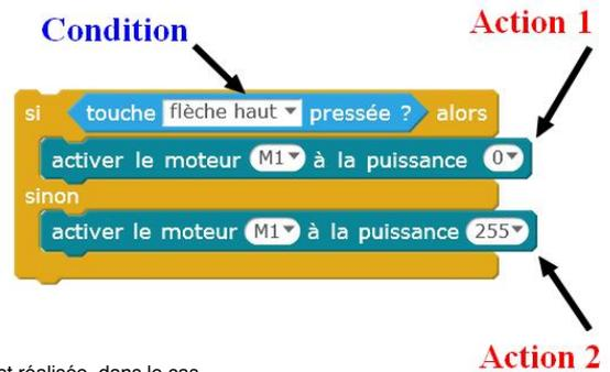
Si la condition est remplie ( OUI ), l'action 1 est réalisée, dans le cas contraire (NON), c'est l'action 2 qui est réalisée
