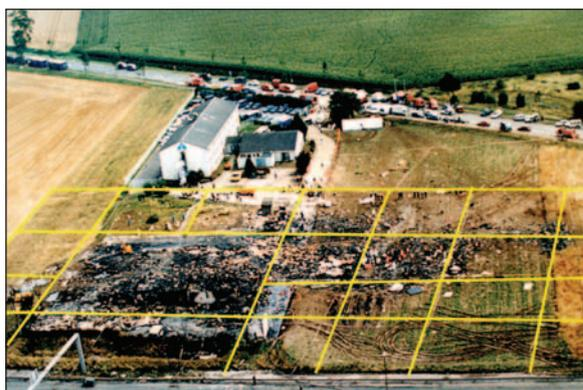
Quadriller une zone pour positionner les différents éléments (objets, débris humains).
