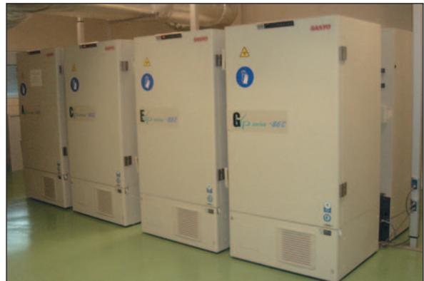
*Le stockage définitif des scellés congelés est réalisé au moyen d'enceintes de cryoconservation à - 80° C.*
