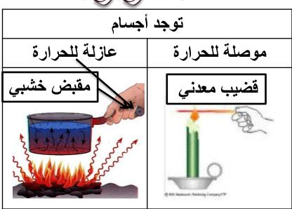
التبادل الحراري هو انتقال الحرارة من الجسم الأكثر سخونة إلى الأقل سخونة .
