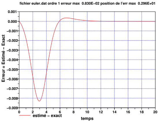
FIGURE 2 – Erreur dans l'intégration de l'équation logistique avec la méthode d'Euler pour h = 0,02 . L'allure régulière montre que l' erreur de troncature domine. Erreur de troncature locale liée à la courbure de la solution
