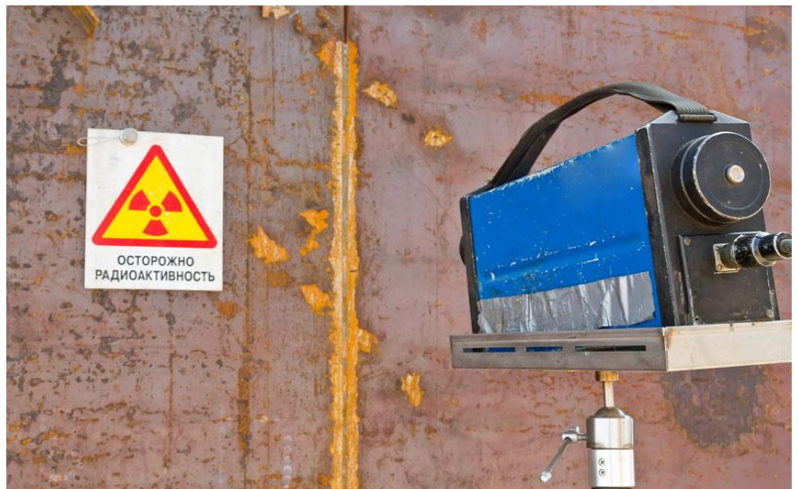
מצלמת רדיוגרפיה תעשייתית המשמשת לבדיקת רתוך אחר פגמים.
