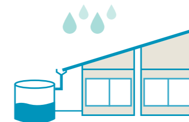
Fig. 5: Captación de agua de lluvia
