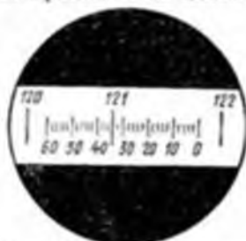
Рис. 26. Вид поля зрения отсчетного микроскопа (отсчет угломерной головки равен 121^{\circ}34' )
