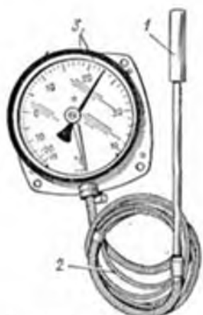
Рис. 46. Электроконтактный термометр ТПГ-СК: 1 — термобаллон, 2 — капилляр, 3 — показывающий прибор
