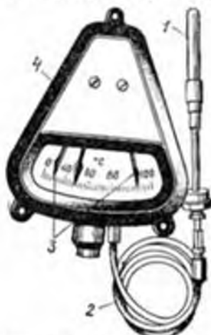
Рис. 47. Электроконтактный термометр ТС-100: 1 — термобаллон, 2 — капилляр, 3 — задатчик температуры, 4 — прибор
