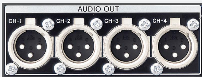
En estos equipos, el nivel de referencia de +4 dBu, equivale a 1,228 Volts, y generalmente utilizan conectores balanceados del tipo XLR o TRS.
