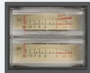
Los sonidos por debajo del 20% de modulación se acercan tanto al piso de ruido que suelen ser inutilizables. Cuando graban, los operadores suelen modificar levemente la ganancia para mantenerse entre el 60 y el 100%. Es normal que existan picos por encima de 0 dB VU, aunque no tan altos como para producir distorsión. Los sistemas digitales no tienen una zona de Headroom preestablecida y veremos que las escala de medición que se utiliza es diferente.
