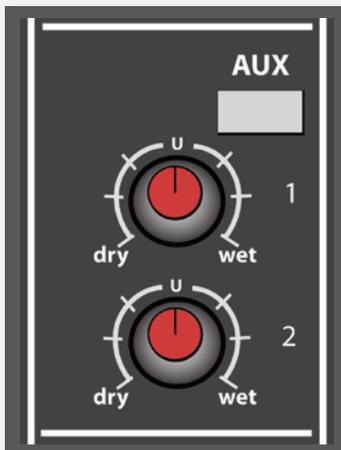
La principal diferencia con los "inserts", reside en que la señal limpia sigue su recorrido a través de los circuitos electrónicos de la consola, a la vez que se "bifurca" y se redirecciona en cierto porcentaje hacia las salidas auxiliares. Esto permite decidir desde la consola qué cantidad de señal se enviará a determinado procesador, cuánto se alimentará a otro procesador y qué proporción de señal se conservará seca o sin procesar.
