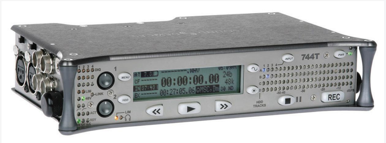
Es un grabador compacto de 4 canales, que utiliza para el registro un disco rígido interno o una tarjeta de memoria (Compact Flash). Graba y reproduce audio en formato PCM (Sin compresión) en 16 o 24 bits, con frecuencias de muestreo desde 32 a 192 kHz. También permite el registro comprimido de audio, en formato MP3 (con ratios que van desde 64 a 320 kb/s)
