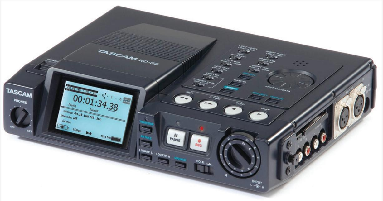
Grabador compacto de 2 canales, utiliza una tarjeta de memoria (Compact Flash). Graba y reproduce audio en formato PCM (Sin compresión) en 16 o 24 bits, con frecuencias de muestreo desde 44,1 a 192kHz en formato BWF. Como se vio antes, este formato consiste en un archivo .WAV al que se le adiciona metadata.
