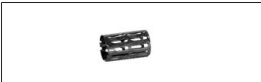
Зажимная втулка имеет 4 пружинных элемента с односторонним креплением, которые располагаются между датчиком и отверстием, в результате чего создается определенное фрикционное соединение между датчиком и отверстием. Датчик удерживается зажимной втулкой таким образом, чтобы при монтаже его можно было сместить до упора в ротор. То есть, в положении при движении он автоматически отходит на минимальный
