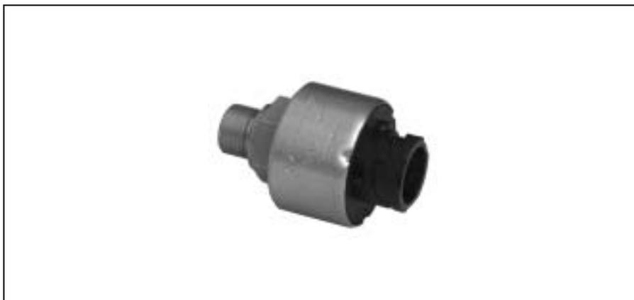
Датчик давления выдает значения напряжения, которые пропорциональны имеющемуся давлению. Диапазон измерения располагается между 0 и 10 бар, нельзя превышать давление 16 бар.
