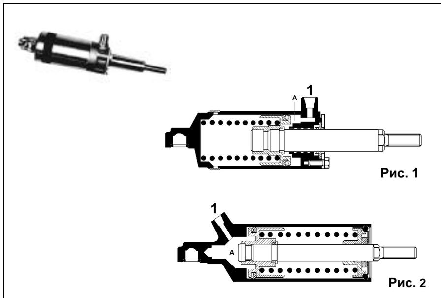
Рабочий цилиндр располагается в системе рычагов между педалью акселератора и рычагом топливного насоса. При срабатывании пропорционального клапана сжатый воздух проходит через вывод 1 в камеру А и перемещает поршень влево. С
