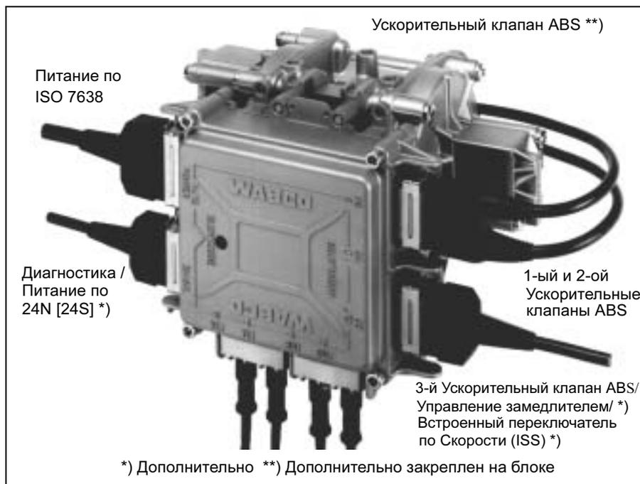
VCS - система ABS для прицепных транспортных средств, которая отвечает всем требованиям для ABS категории А. Имеется выбор вариантов от 2S/2M для полуприцепов до 4S/3M для дышлавых прицепов или, например, для полуприцепов с поворотной осью.
