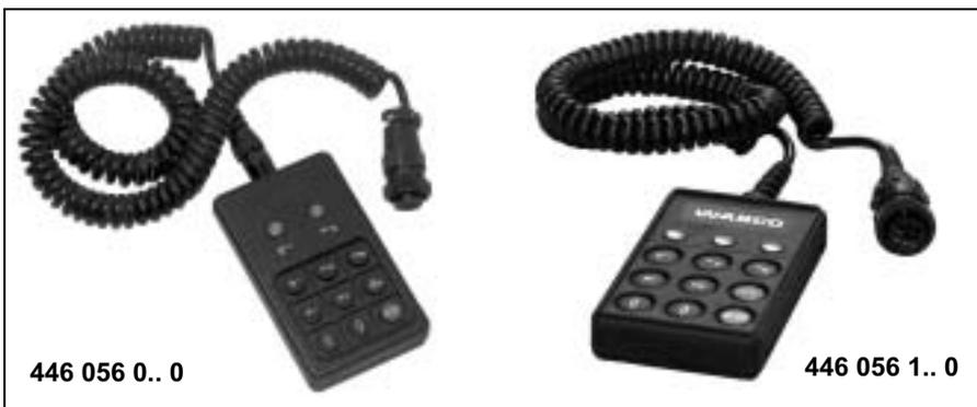
С помощью устройства дистанционного управления водитель получает возможность влиять на уровень высоты автомобиля в допустимых пределах. Предпосылкой изменения высоты является остановка автомобиля или скорость ниже определенной запрограммированной величины.
