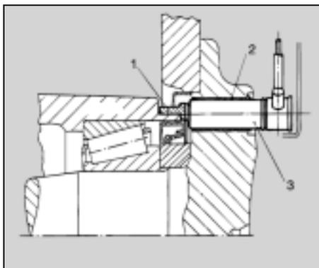
Поворот колеса регистрируется с помощью вращающегося со ступицей ротора (1) и выдающего импульсы датчика (2), который установлен в суппорте тормоза с помощью зажимной втулки. Роторы для средних и тяжелых грузовых транспортных средств имеют по 100 зубьев.
