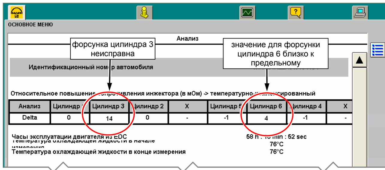
При этом способе измерения утечка между форсункой и штуцером не приводит к изменению температуры или сопротивления либо приводит к незначительному изменению в отличие от утечки внутри форсунки.
