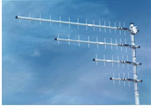
Figura 6. Antena Yagi Utilizada para algunas Aplicaciones de Trunked
