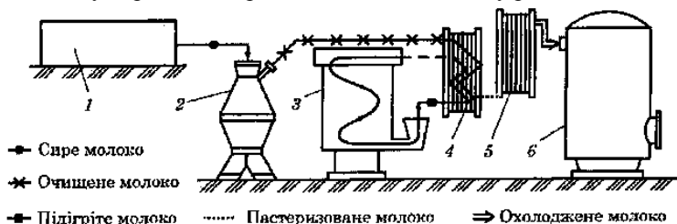
Рис. 2.67. Технологічна схема первинної обробки молока: 1 – молокозбірник; 2 – сепаратор-очисник; 3 – пастеризатор; 4 – регенеративний теплообмінник; 5 – охолодник; 6 – молочний танк
