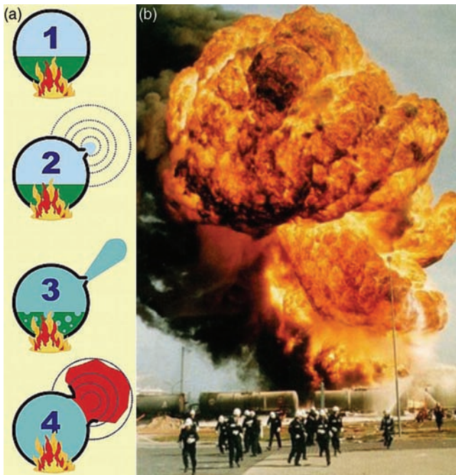
Figure 7.13 A BLEVE. (a) Scheme [16]; (b) Photo of an actual BLEVE in South America [17].
