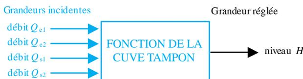
Figure 2.2 Schéma fonctionnel simplifié n°1
